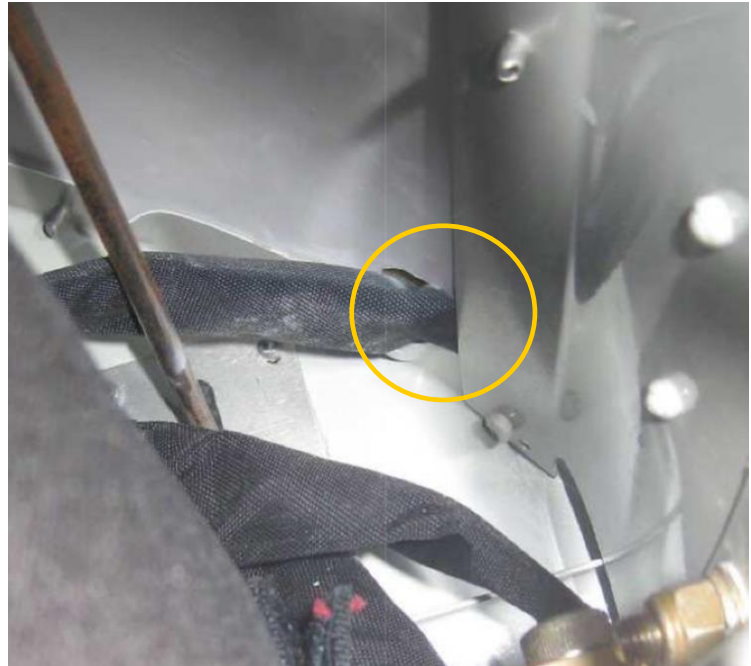
Figure 6: vue de l'intérieur du compartiment avant de parachute indiquant la découpe du coin inférieur du panneau éjectable (cercle jaune) par où le harnais installé sur l'extérieur du fuselage rentre dans le compartiment pour se connecter au parachute.
